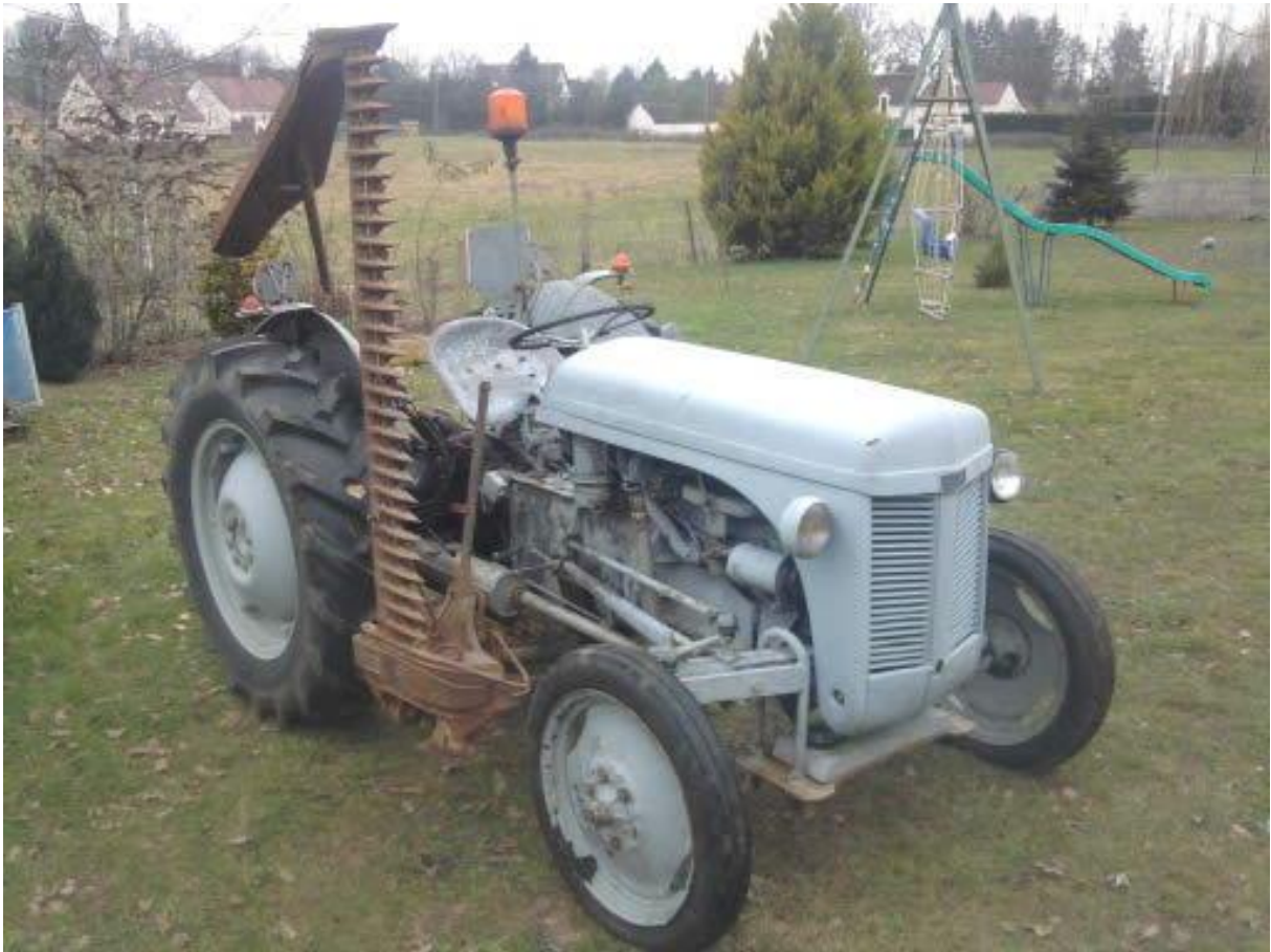
Tracteur Ferguson année 1946. Celui-ci équipé d'une barre de coupe latérale. Il tourne encore.
